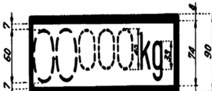
Slika 1. Oznaka obilježavanja vlastite mase vagona opremljenog ručnim kočnicama
