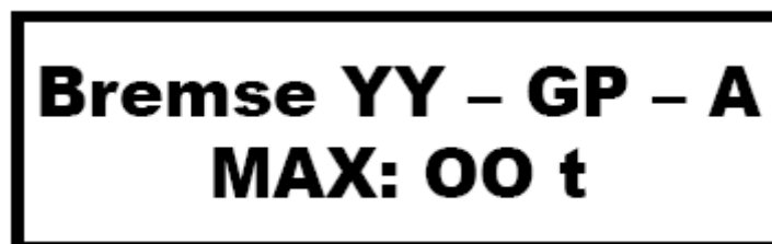
Slika 32. Oznaka za vagon s automatskim kočenjem ovisno o teretu
