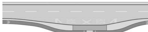
Slika 37. Vođenje biciklističke staze uz autobusno stajalište s ugibalištem
